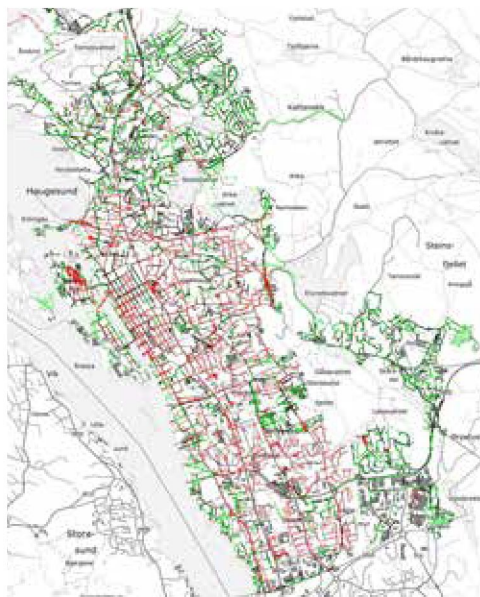
Figur 7-7 : Avløpsnettet sentralt i Haugesund. Avløp-fellesledninger er markert med rødt, separatsystem med grønt og svart. Røvær har nær 100% separatsystem (ikke presentert i kartet). Nordbygdene har i liten grad offentlige spillvannsledninger og er ikke presentert.
