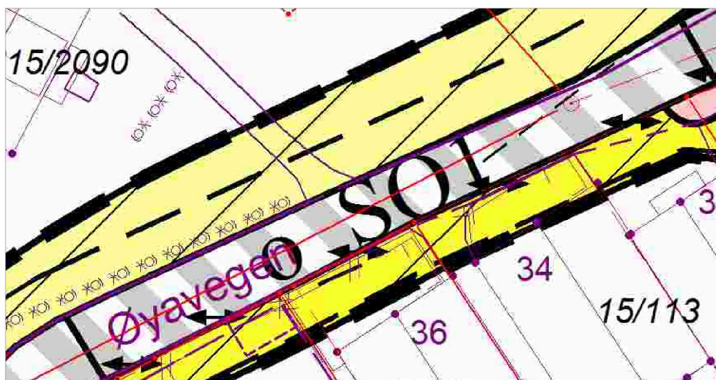
Figur 6. Utsnitt av planforslaget, dagens situasjon i lilla strek, eiendomsgrensener med rød strek
