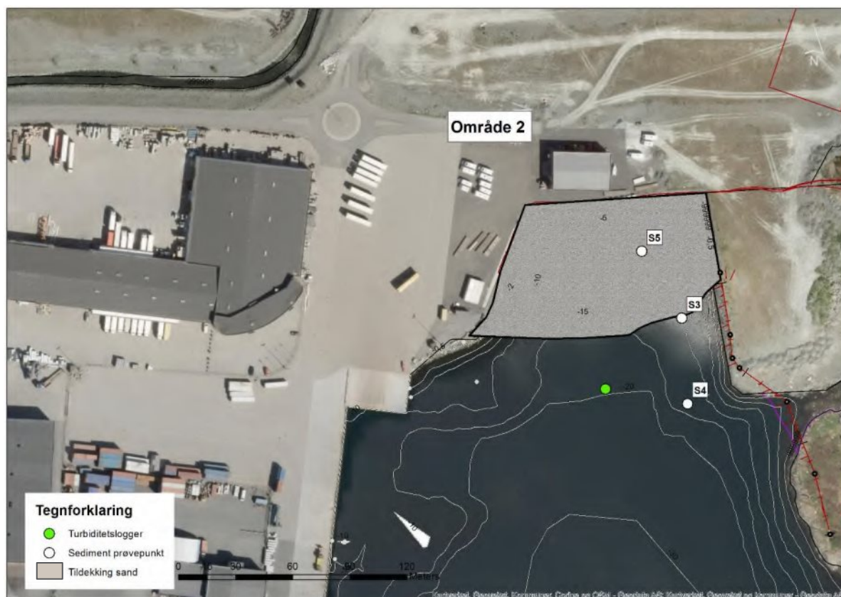
Figur 4. Forslag til forberedende tiltak og overvåking under tiltak. Overvåkingsstasjonen med turbiditetslogger kan med fordel være montert på en sedimentfelle slik at en kan beregne total spredning i løpet av tiltaket.
