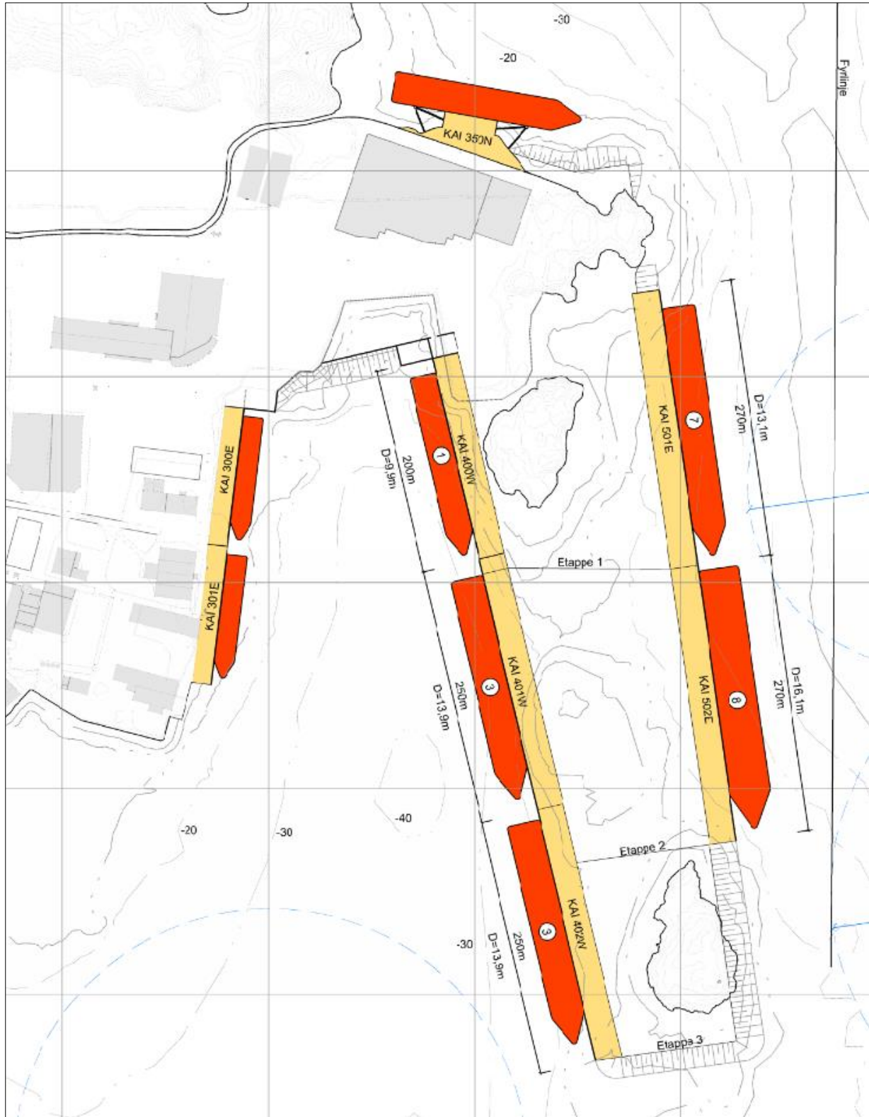
Figur 18 Kaiens utforming er tilpasset aktuelle skip. Utsnitt fra Havneplan 2017, tegning 2.
