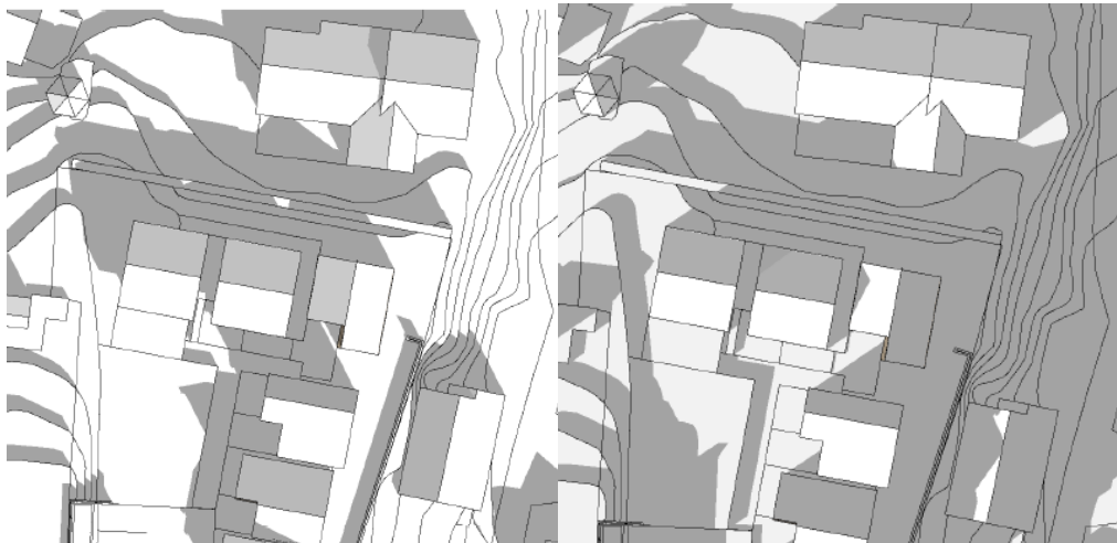
Figur 6: Utbygging av området etter planforslaget ved vår- og høstjevndøgn kl. 12.00 til venstre og kl. 18.00 til høyre. Eksisterende hekk er også illustrert på soldiagrammet.
