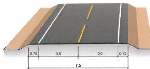
Figur C.8: Tverrprofil Hø2, vegbredde 7,5 (mål i m)
