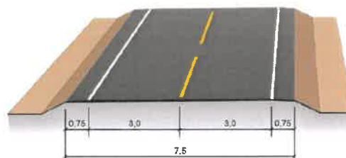
Figur C.6: Tverrprofil Hø1, 2-feltsveg, vegbredde 7,5 (mål i m)
