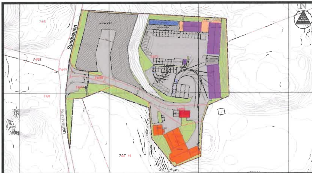
Figur 3-08 – 1-Alt., det blir asfaltert i hele vestlige del av industriområdet og brakkebygg mot nord fjernes.
