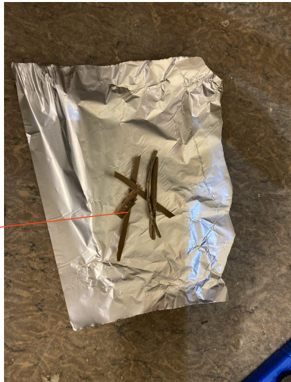
Figur 9: Fug mellom brun vinyl ble prøvetatt for asbest, prøve T13 . Det ble ikke påvist asbest i prøven.
