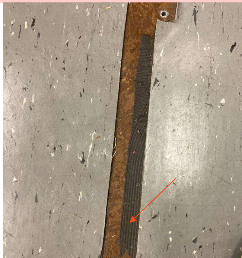
Figur 5: Det ble ikke påvist asbest i limen mellom brun og grå vinyl i rom 112, prøve T7 .
