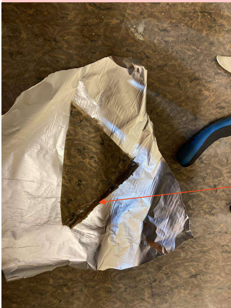
Figur 8: Brun vinyl ble prøvetatt for asbest, prøve T12 . Det ble ikke påvist asbest i prøven.
