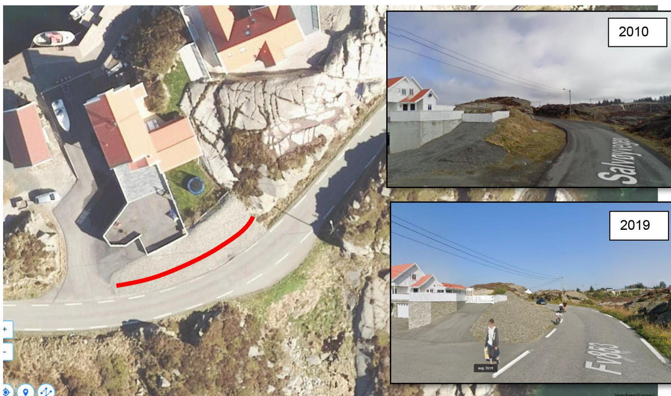
Figur 9: Mur 3 omtrentlig tegnet inn med rød strek. Mur 3 skal etableres i en skråning dekket av pukk. Det er antatt skråningen består av fyllmasser etablert for tilkomstvei for Salvøyvegen 81.
