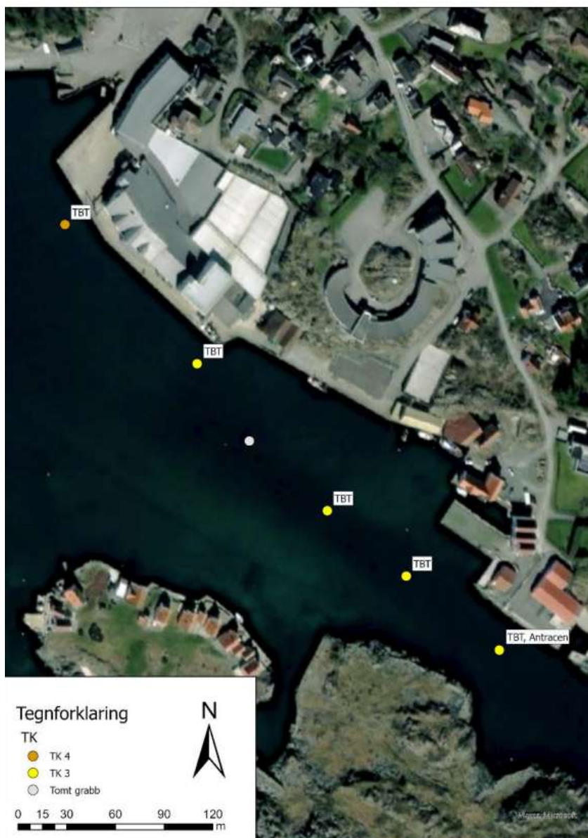
Figur 23 Oversiktskart av prøvetakingspunkter fremstilt etter høyeste påviste tilstandsklasse. Kilde: figur 6, COWI 01.2022
