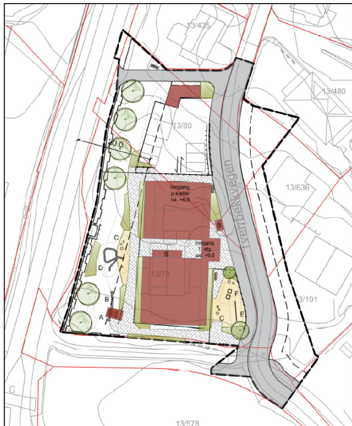
Utomhusplan som viser bygningenes planlagte plassering, og opparbeidelse og bruk av arealene for øvrig.
