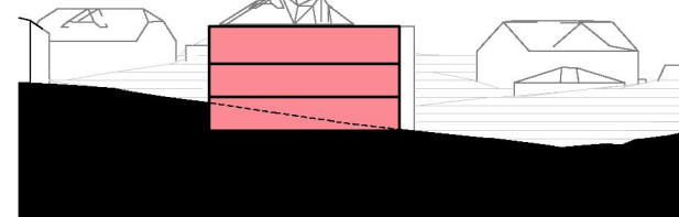
Snitt 4b teknisk rom og lager ligger uten tilgang til dagslys, mindre terrenginngrep, ingen pga. dagslys
