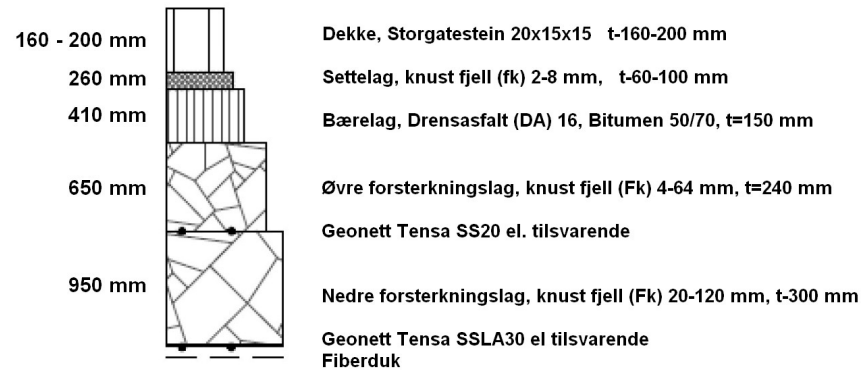
Prinsipp for tilkoping mot eks. veioverbygning- I lengderetning, snitt
