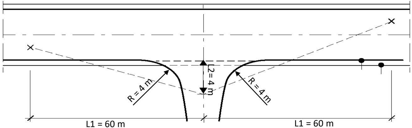
Innenfor siktrekanten,  $L_2 = 4$  meter inn i avkjørselen og  $L_1 = 60$  meter til venstre og høyre, skal eventuelle sikthindringer ikke være høyere enn 0,5 meter over primærvegens kjørebanenivå. Planet mellom øyepunkt i avkjørselen og kjørebanen i primærvegen skal være fritt for sikthindringer.
