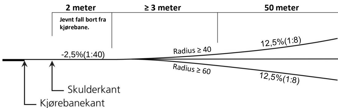
På de første 2 m fra veggkanten, bør avkjørselen ha et jevnt fall fra veggkant på -2,5 % (1:40).
