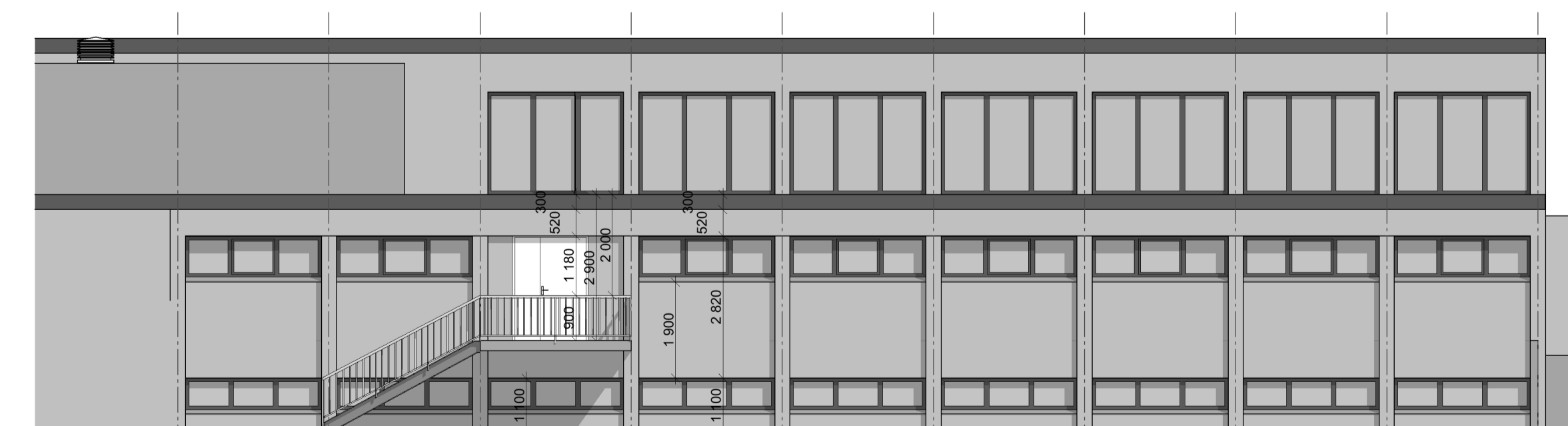
Fasade ny rømningstrapp
