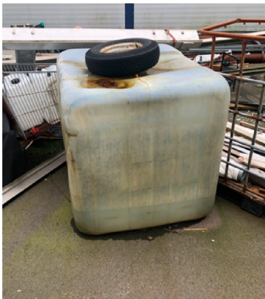
Bilde 4: Umerket IBC uten lokk med skade i siden. Det fremstod som at innholdet var oljeholdig vann.
