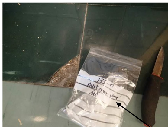
Bilde 36 viser blågrønn vinylflis som er prøvetatt (prøve 133-P1). Det er ikke påvist asbest i de mørke flisene.
