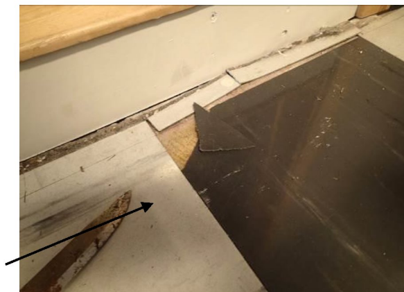
Bilde 17 viser prøve av grå vinylflis i rom 046. Det ble ikke påvist asbest i flisen.
