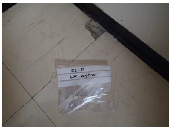
Bilde 34 viser hvit vinylflis i rom 122. Det ble ikke påvist asbest i prøven.
