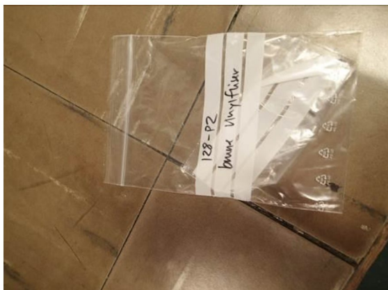
Bilde 11 viser brun vinylflis i rom 128. Flisene er asbestholdige.
