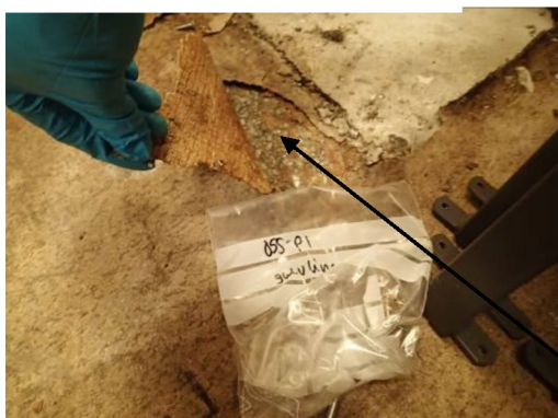
Bilde 33 viser gulvlim som ble prøvetatt i rom 055. Det ble ikke påvist asbest i prøven.
