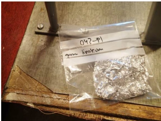
Bilde 42 viser grønt linoleumsbelegg i rom 043, som ble prøvetatt for bly (043-P1)
