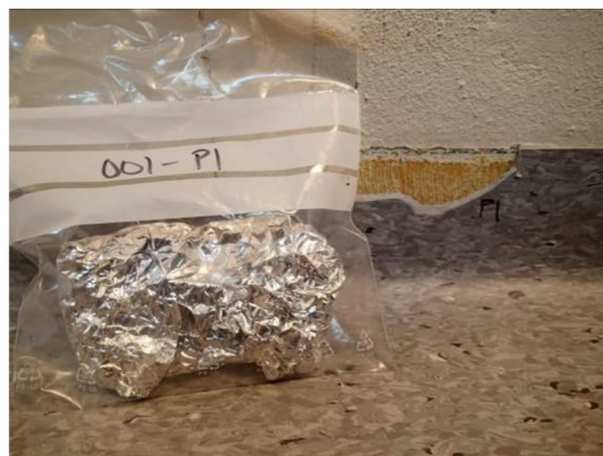
Bilde 15 viser prøve 001-P1 av grått vinylbelegg. Det ble ikke påvist asbest i belegget.
