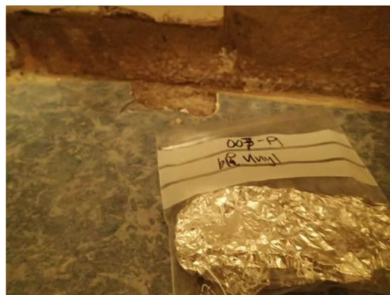
Bilde 16 viser blått vinylbelegg i rom 007. Det ble ikke påvist asbest i prøven.
