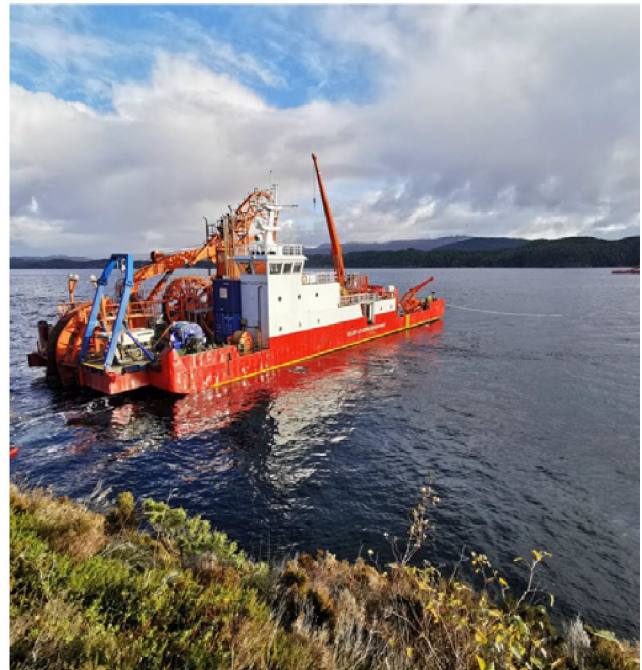
Å legge kabler i sjø krever spesialkompetanse og -fartøy som dette kabelskipet Nautilus Maxi.
