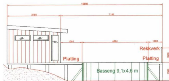
Figur 3 - Tegning av basseng og platting
