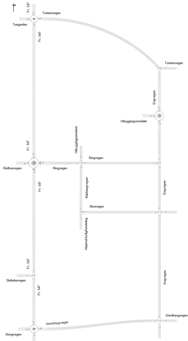
Figur 3-3: Utforming av vegnettet i SIDRA, fremtidig situasjon med ny veg og stengt Åkravegen x fv. 547.
