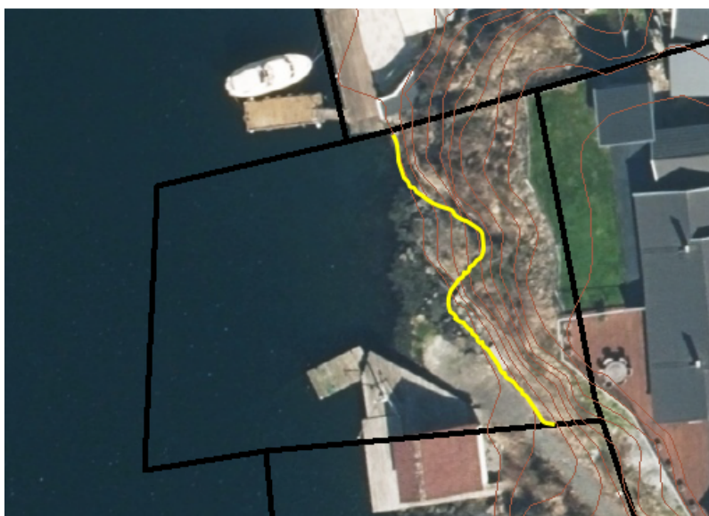
Figur 3: Areal til høyre for den gule streken er for bratt til å utnyttes. Det er ca. 6 høydemeter i forskjell mellom streken og nivået husene ligger på.
