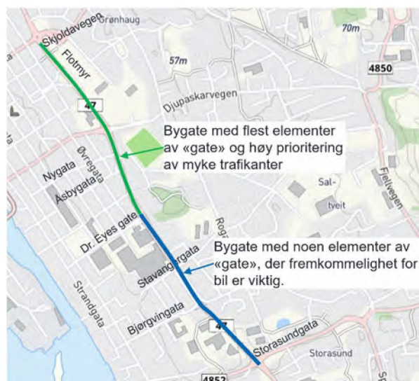
Figur 2.10: To-delt strategi for utvikling av Karmsundgata, med litt ulik grad av gateelementer og prioritering av mange trafikanter i «Karmsundgata Nord» og «Karmsundgata Sør».
