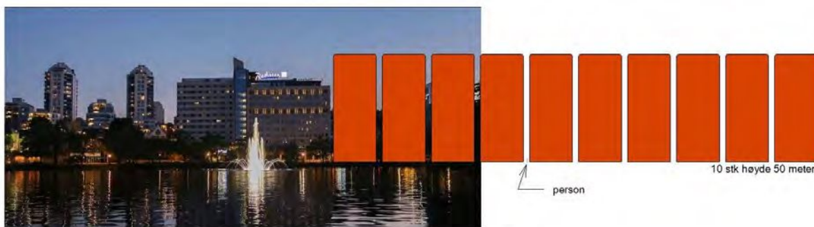
Figur 1: 10 av 20 planlagte tanker sammenlignet med Hotell Atlantic i Stavanger og størrelsen på en person.
