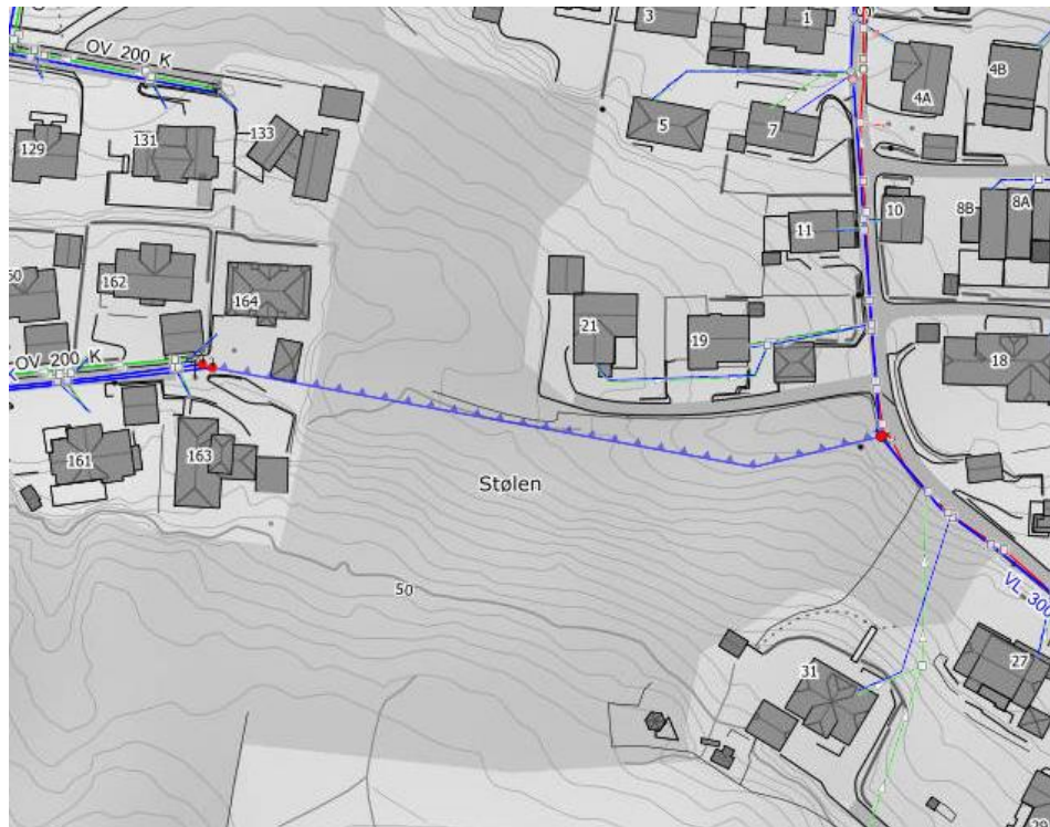
Bilde 1: Ny vannledning Stølen-Eidsbakkane, 500 PE
