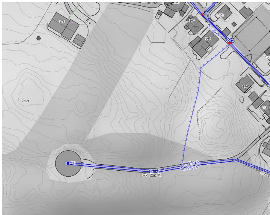
Bilde 2: Ny vannledning Stangalandstølen-Høydebasseng, 500 PE
