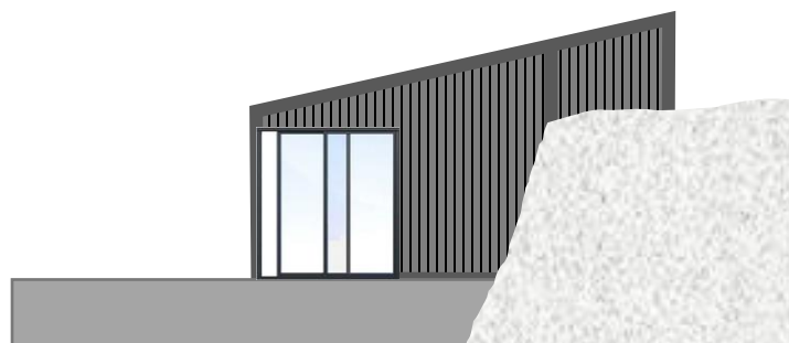
Fasade mot nord bygges inntil terreng/berg
