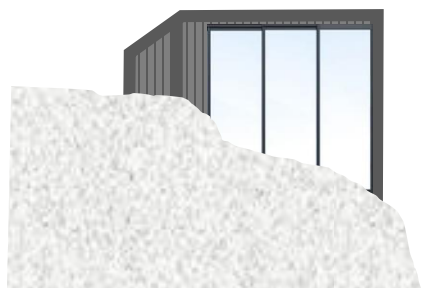
Fasade mot vest bygges inntil terreng/berg
