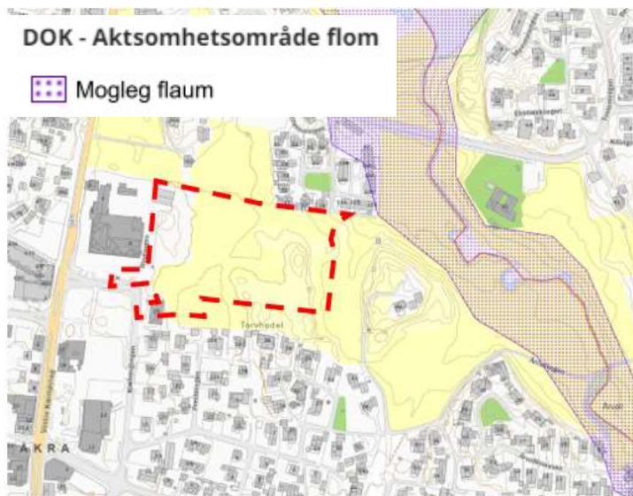
Figur 35 Aktsomhetsone flom. Ca. planområde er vist med rød, stiplet strek. Kilde: temakart-rogaland.no
