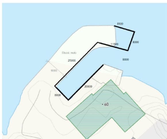
Figur 1 - Skisse av endring av molo. Figur er henta frå søknaden.
