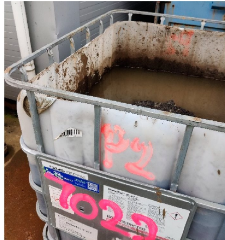
Figur 3: IBC med forurenset grus lagret utendørs med oppsamlet regnvann
