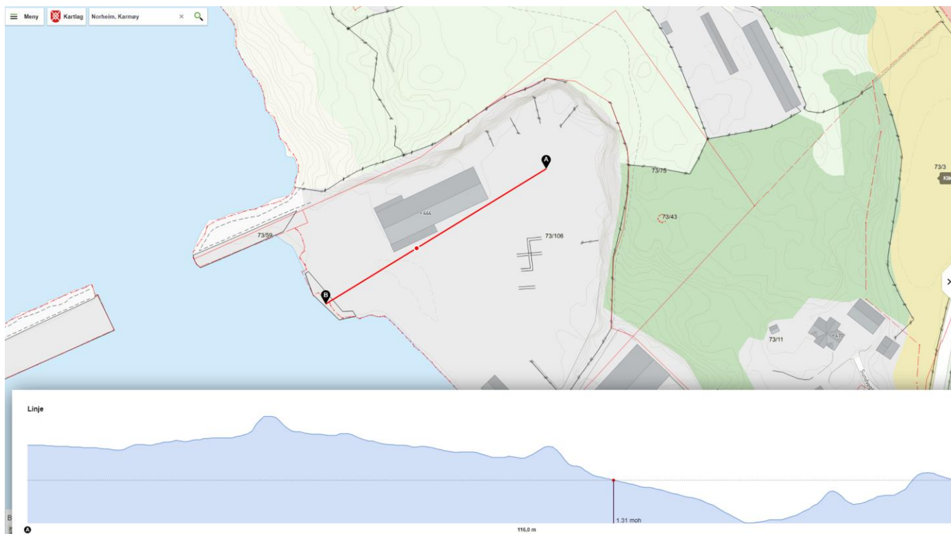
Figur 4 Terrengmodell over tomte. Rød markør viser kotehøyde 1,3.
