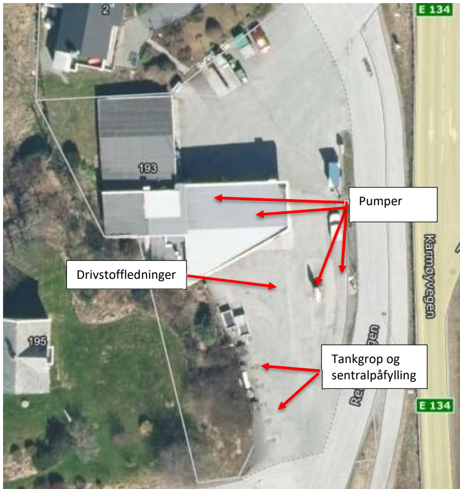
Figur 2. Foto som viser stasjonen samt drivstofftekniske installasjoner (kartkilde: 1881.no).
