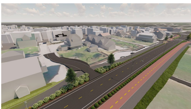
Figur 35: 3D-illustrasjon av sykkelveg med fortau på østsiden, gang- og sykkelveg på vest side av fylkesveg. Nytt kryss midt på strekket.
