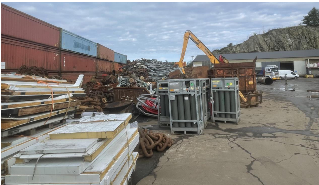
Figur 3 Dagens støyskjerm av containere til venstre i bildet
