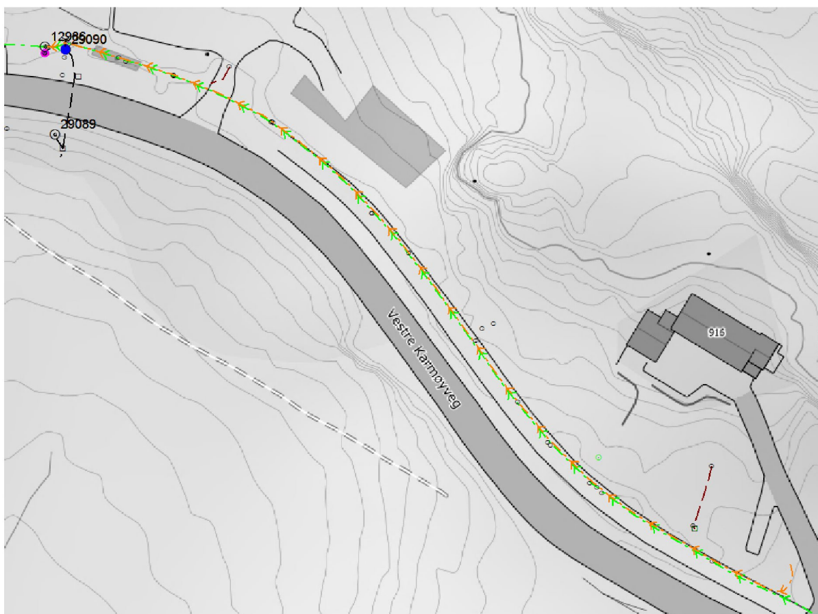
Figur 1 Privat pumpeledning lagt opp til eiendom er markert med oransje. Kum 12986 er kummen som erstattet kum 58244 som blir referert til fra klager. Grøn pumpeledning er pumpeledning som er lagt opp til nabo
