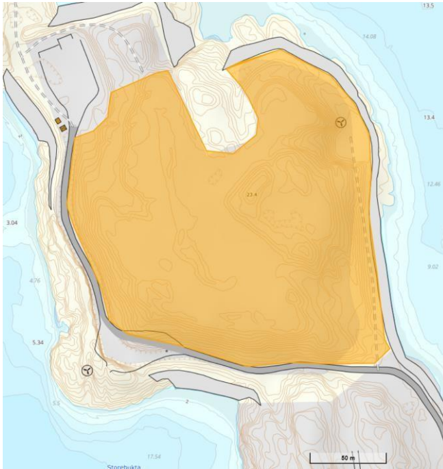
Figur 15 Deponiarealet er beregnet til 23400 m 2 , utgangspunkt er plassering av avskjærende grøfter på utsiden av deponiarealet og det historiske flybildet fra 2001 som viser at i nordlige del ikke var deponi med et driftsområde.
