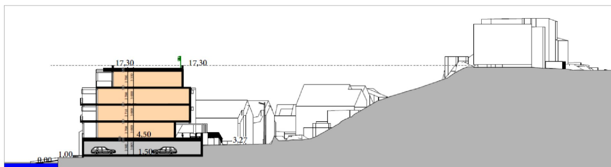
Figur 9: Tverrsnitt av Stølebuktvegen
