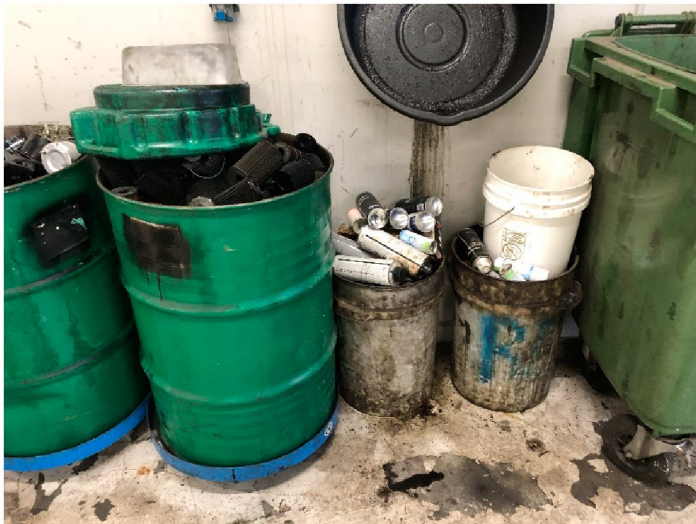
Bilde 1: Lagring av oljefilter og spraybokser (farlig avfall) inne på verkstedet
