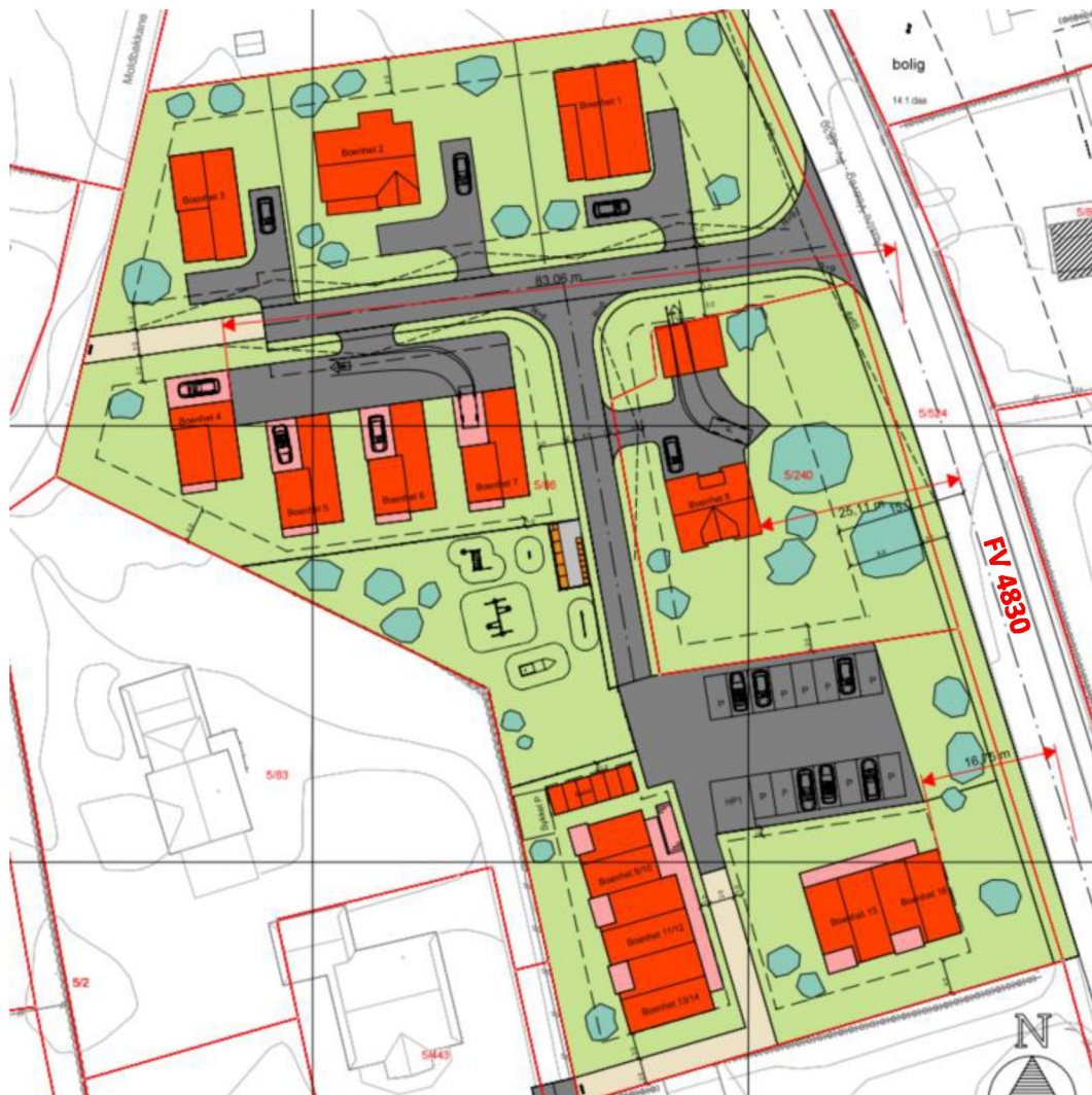
Figur 1: Utklipp av situasjonsplan for planid 2135, Østre Moldbakkane, Karmøy kommune, RH Oppmåling. Boligen ligger på det korteste 16,7 m vest for FV 4830 Austre Veaveg.
