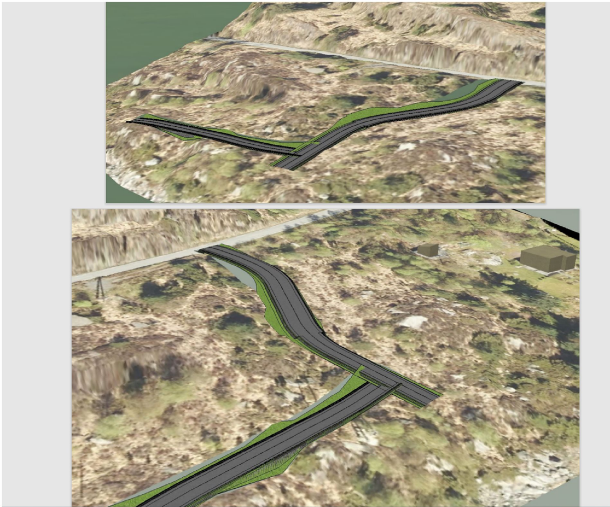
Figur 7: Illustrasjon av planlagt anleggsvei. Kilde: COWI AS
