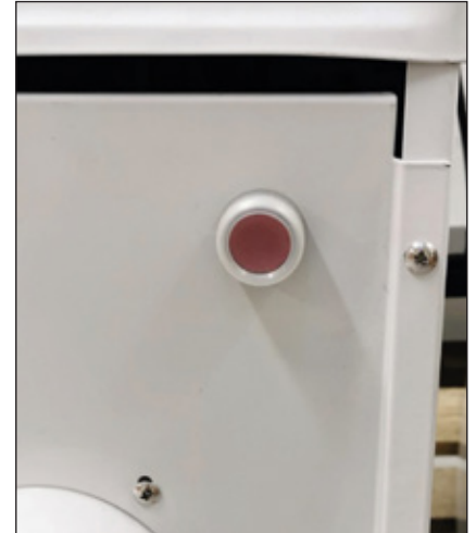
Pidä peruutuspainiketta painettuna, jos luukut eivät sulkeudu kunnolla.
