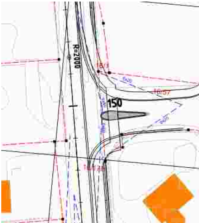
Utsnitt fra geometritegning, forslag til dråpeøy i sideveg med gangareal.
