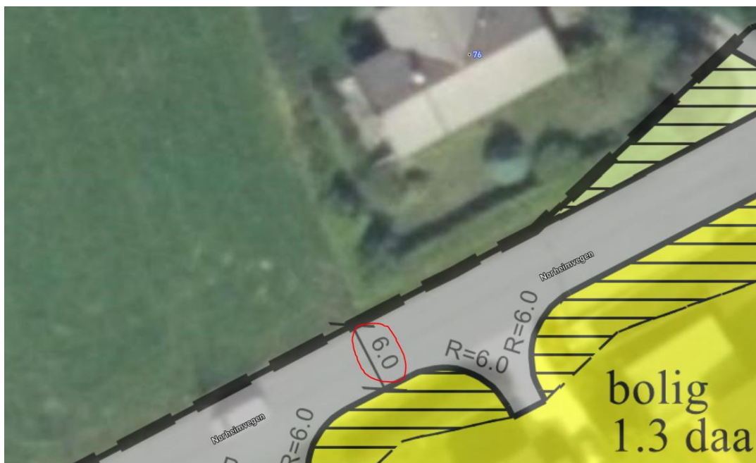
Figur 5: Bredde på kjørebane, ca. 6.0m, ved Norheimvegen 76
